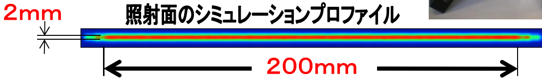
UVL-1 ライン方向のプロファイル @IF=420mA WD=22mm
